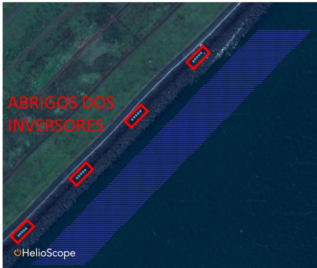
Figura 3 - Distribuição dos 3600 módulos e 20 inversores em 4 abrigos de alvenaria
